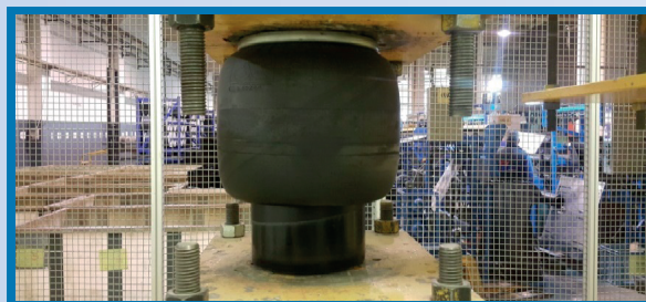
Тест камеры пневморессор Peга
