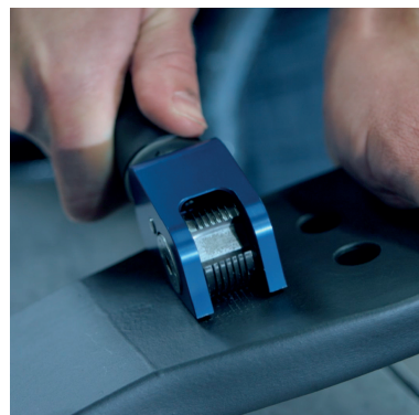
Проверка качества окраски
