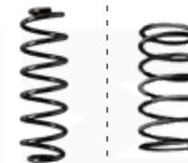
Дешёвые пружины изготавливают по устаревшей технологии из незакалённой стали. Поэтому пружина просаживается уже в первые недели эксплуатации. Это приводит к уменьшению дорожного просвета и повышенной нагрузке на амортизаторы.
