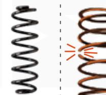
Проседание, уязвимость к коррозии, усталость металла дешёвых пружин — не только снижают комфорт и ухудшают управляемость, но и негативно влияют на безопасность: такая пружина может лопнуть.
